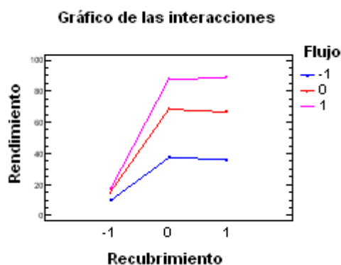
Figura 6: Efectos de la interacción recubrimiento-flujo sobre el rendimiento
